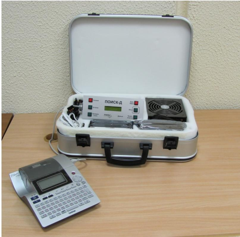
Копирование осуществляется путем подключения Комплекса к сетевому порту или порту USB компьютера (то есть без изъятия накопителя информации из компьютера).
